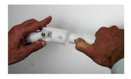
Schnellverriegler des Teleskopgriffes eindrücken und in den Kardangelenkadapter stecken.
