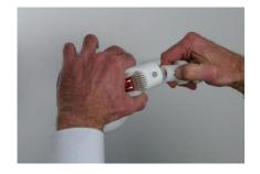
Danach Schnellverriegler des Kardangelenkadapters eindrücken und in den Saugkopf schieben.
