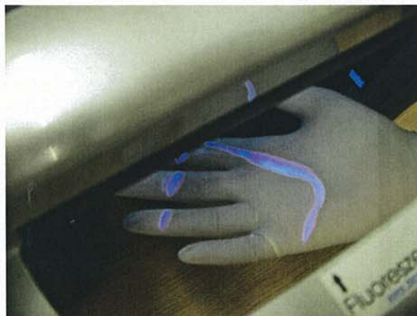
Abb.7: Kontaminationsübertragung vom Betätigungsbügel auf die Handinnenfläche
