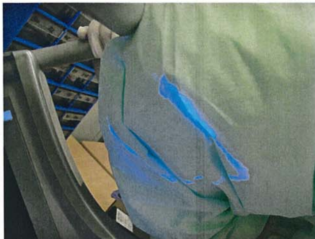
Abb.8: Kontaminationsübertragung vom Betätigungsbügel auf den Ellenbogen
