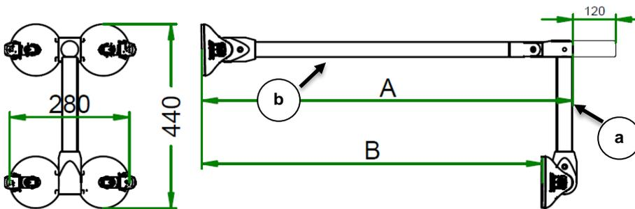
Durch das Mobeli Baukastensystem kann das zusätzliche Griffverlängerung von 120 mm auch nachträglich angebracht werden.
